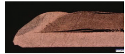
30 x 8µm Cu Foil on 254 µm Cu Lead
