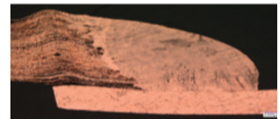
70 x 8µm Cu Foil on 254 µm Cu
