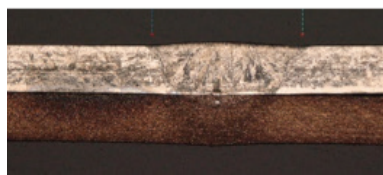
200µm Cu on 200µm SS
