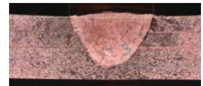
2 x 200µm Cu on 400µm Cu
