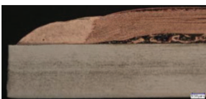
70 x 8µm Cu foil to 500µm SS Tab
