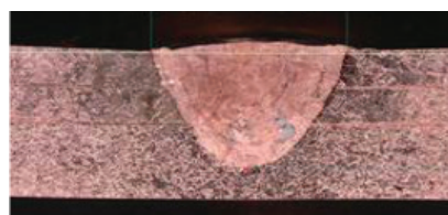
2 x 200µm Cu on top of 400µm Cu
