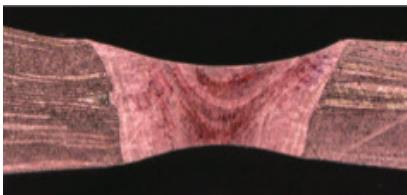
40 x 10µm Cu foil
