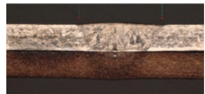
2 x 200µm Cu & SS Lap
